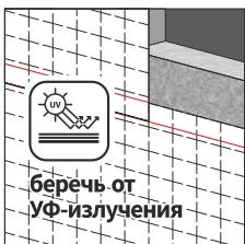
**9.** Не допускается нахождение плёнки под солнцем. Монтаж кровли должен быть выполнен сразу же после монтажа плёнки.
